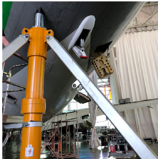
J-POD55，宽体机机身千斤顶，也有单级或多级版本，适应复杂工况条件。
