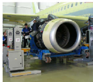
J-SEL1105，目前运行于俄罗斯苏霍伊飞机制造工厂生产线，1米举升高度，荷载5吨。
