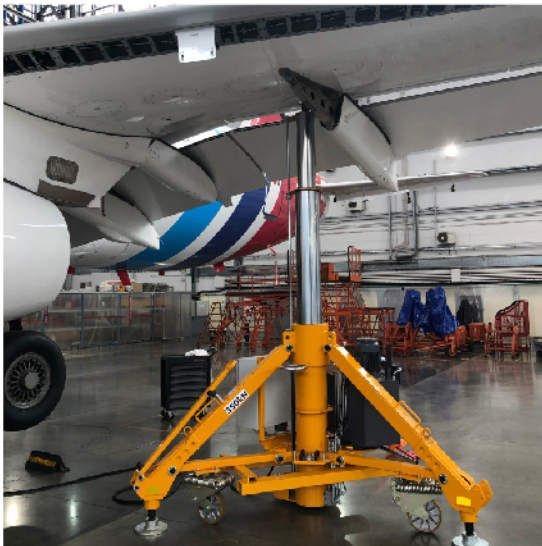
J-POD35，窄体机机身千斤顶，也有单级或多级版本，适应复杂工况条件。
