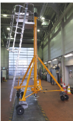
J-STAY747，B747货机尾撑，适合所有需求。
